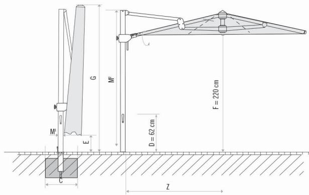
Loser Deckbelag max. 10 cm, Betondicke min. 30 cm
