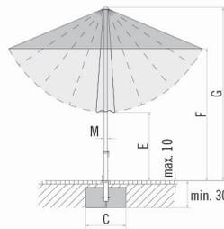
Loser Deckbelag max. 10 cm, Betondeicke min. 30 cm (Frosttiefe beachten), Wasserabfluss.
