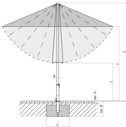
Loser Deckbelag max. 10 cm, Betondicke min. 30 cm
